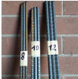
**ACCIAI: prova di trazione e piegamento (3 barre da almeno 120**
