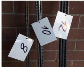
**ACCIAI: prova di trazione e piegamento (3 barre da almeno 120**
